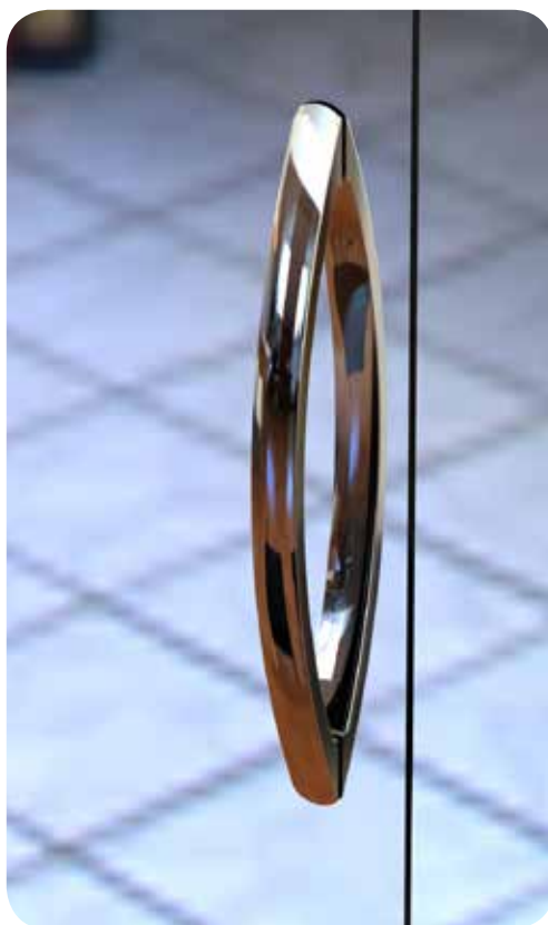
编号: LQ63 名称: 月亮型拉手 (D 型) 材料: 不锈钢 参数: 30X15mm D 型管 孔距: 400mm
