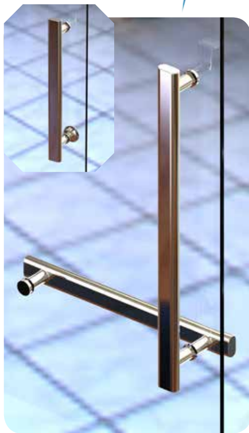
编号: LQ50 名称: 扁拉手 材料: 不锈钢 参数: 30X15mm 管 孔距: 450X300mm(可订制不同长度)
